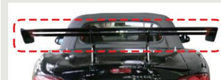
**基準** 側方への翼形状を有していないこと。確実に取り付けられていること。鋭い突起がないこと。その付近の最外側、最後端とならないこと。など。
