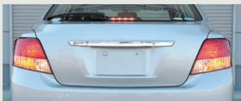
① エンジン・スイッチをONにして、ヘッドランプ、テール・ランプ、ライセンス・ランプ、ブレーキ・ランプ、クリアランス・ランプ、バックアップ・ランプなどの点灯具合やウインカ・ランプの点灯具合及び点滅速度が不良でないかを点検します。フォグランプ付車はフォグランプの点灯具合も点検しましょう。
