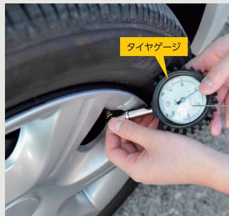
タイヤの接地部のたわみの状態により、空気圧が不足していないかを点検します。なお、タイヤゲージがあれば、より正確に点検できます。
