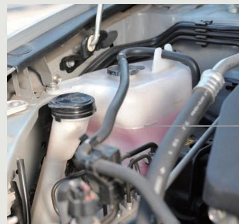
ラジエーター・リザーバ・タンク内の冷却水の量が規定の範囲 (FULLとLOWの間) にあるかを点検します。
