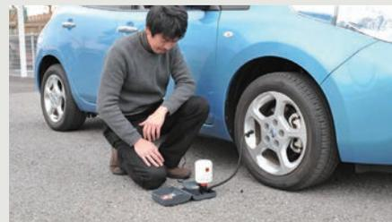
**6** 空気圧が上がったら、コンプレッサーのスイッチをOFFにし、電源プラグを電源ソケットから抜き、注入ホースをタイヤのバルブから抜きます。
