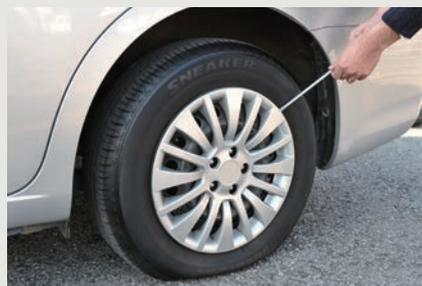
5 パンクしたタイヤの近くのジャッキアップ・ポイントを確認します。
