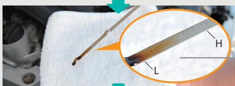
④ もう一度抜いてオイルの量がオイル・レベル・ゲージの規定の範囲内(HとLの間)にあるかを確認します。
